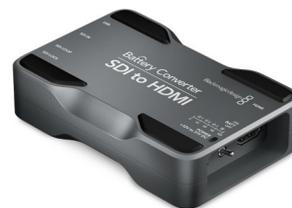
Die ideale Lösung, um direkt am Drehort Kameraausgänge an HDMI-Monitore zu koppeln. Der akkubetriebene, super robuste Battery Converter SDI to HDMI trumpft mit automatischer SD/HD-Umschaltung und einem durchgeschleiften SDI-Anschluss für zusätzliche Geräte auf. Enthält einen integrierten, aufladbaren Lithium-Ionen-Polymer-Akku und ein externes Netzteil.
