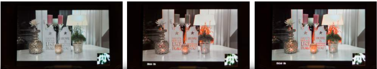
Farbbild ohne Kantenanhebung -> S/W Bild mit Kantenanhebung -> Farbbild mit Kantenanhebung
