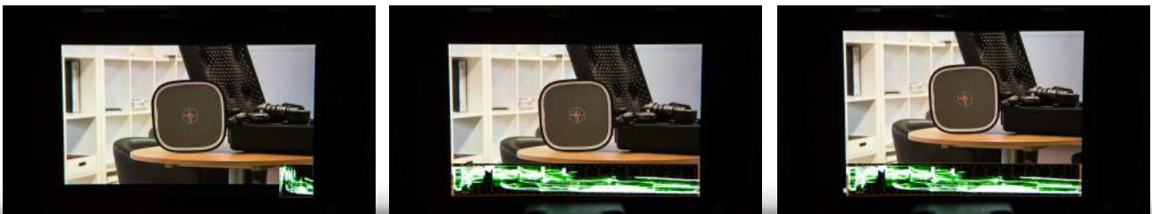
WFM unten rechts, WFM gestreckt unten überdeckend, WFM gestreckt + skaliertes Bild
