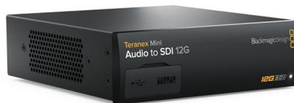
Besorgt die Einflechtung von bis zu zwei Kanälen Audio von symmetrischen Analog-, Glasfaser- oder HiFi-RCA-Eingängen, oder von vier Kanälen von AES/EBU-Digitalaudio in beliebige SD-, HD-, Ultra-HD- oder DCI-4K-SDI-Videoanschlüsse. Nehmen Sie das Audio von Geräten wie Audiomixern, iPods und analogen MAZen und betten Sie es zum Gebrauch mit SDI-Kreuzschienen und -MAZen in die SDI-Videoanschlüsse ein.
