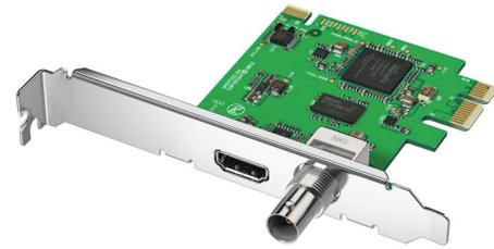
Monitoring von unkomprimiertem 10-Bit-Video von Ihrem Computer aus! Mit 3G-SDI- und HDMI-Ausgängen zum Anschließen beliebiger Fernsehgeräte oder Computer. Der DeckLink Mini Monitor schaltet automatisch zwischen SD und HD hin und her und kann so alle gängigen Videoformate bewerkstelligen. Der DeckLink Mini Monitor ist die perfekte Lösung für das Monitoring über Schnittsoftware bei gleichzeitiger Bearbeitung! Beinhaltet zwei PCIe-Blenden für Standard- und Low Profile-Steckplätze.
